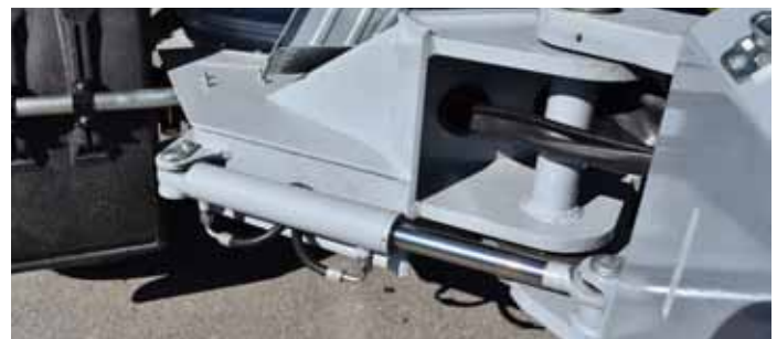
Robustes Zentralgelenk mit Knickwinkel +/- 35° und Pendelwinkel +/- 12°
