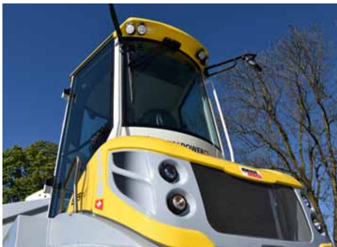
180° drehbare Kabine mit geräumigem, ergonomischem Cockpit
